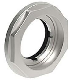
Adapter do zmiany średnicy otworu z Ø30mm/1,18" na Ø22mm/0,87" LPXA161M
