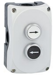
Pulsantiera grigia LPZP2A8 completa con pulsante rasato bianco "freccia destra" LPCB1148 1NA e pulsante rasato nero "freccia sinistra" LPCB1142 1NA LPZP2B8903
