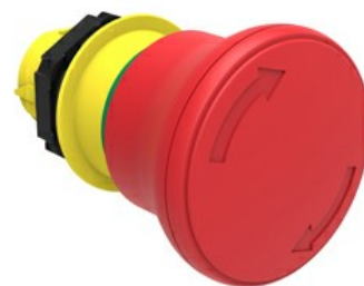
Operatore pulsante a fungo, ad aggancio sgancio a rotazione Ø 40mm LPCB664
