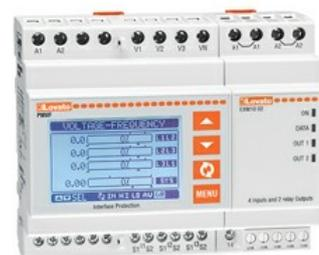
Sistema di protezione di interfaccia - Conforme guida tecnica G59 (ENA) PMVF70
