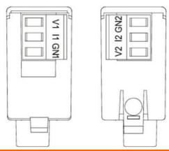
Connessione per uscita di corrente Current output connection Connexion pour sortie en current Conéxion salida corriente
