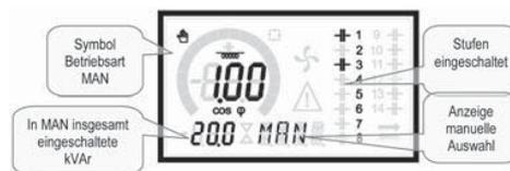
▼ ▲ Stufe auswählen    MODE Stufenstatus ändern
