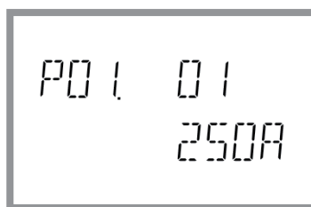
Setup: selecting the parameter number
