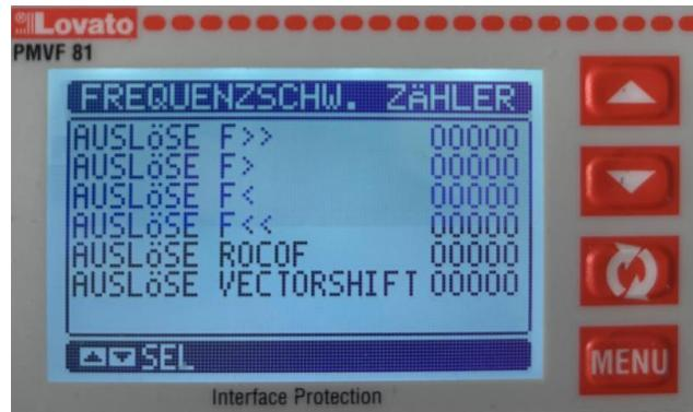
Zurücksetzen des Auslöse Zählers via „BEFEHLSMENÜ“ – Unterpunkt: C40 „RESET EVENT LOG“ möglich:
