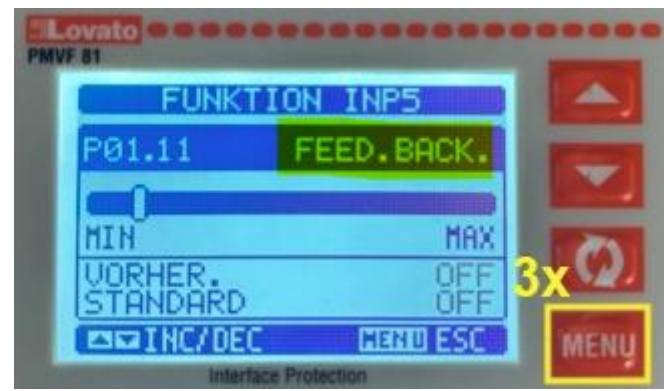
Nach 3x „MENU“, startet das Gerät kurz neu und Eingang (INP) 5 ist als Status Rückmeldung des „Backup“ Kuppelschalters konfiguriert.
