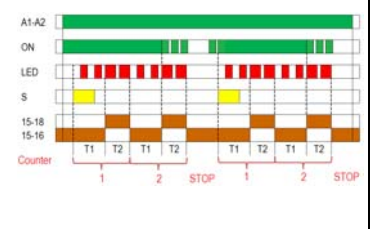
Example 2: Funktion Cc, Preset counter = 2.
