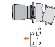
**Si el contacto LPXC01M se separa del actuador** a causa de **fuertes choques o vibraciones**, el aparato solo podrá ponerse nuevamente en funcionamiento restableciendo el montaje correcto del contacto en el actuador, con el consiguiente cierre del **contacto .3-.4**.
