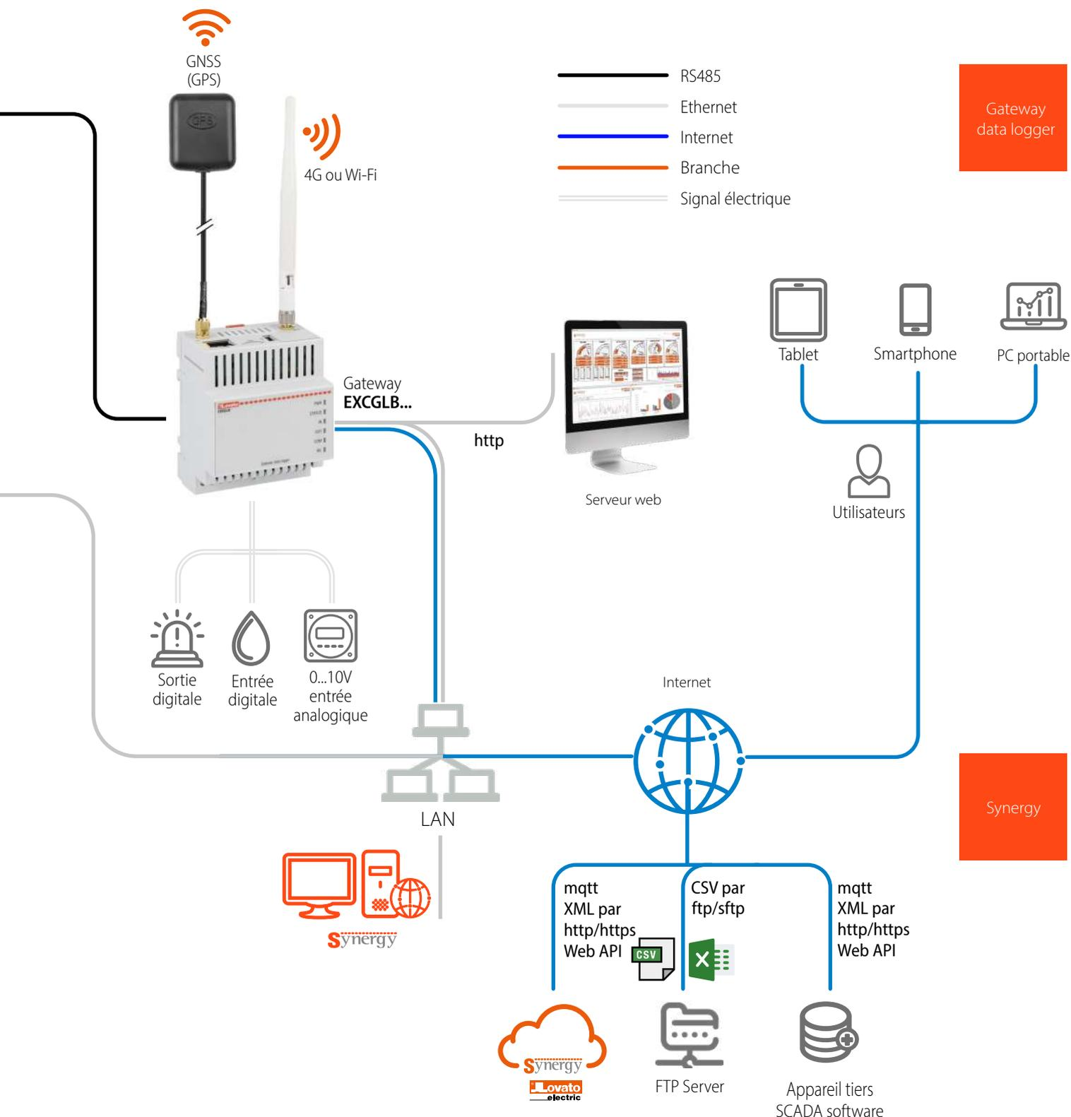
**Synergy** par LOVATO Electric est un système de surveillance et d'analyse de l'énergie avec une approche professionnelle, flexible et intégrée du point de vue Industrie 4.0. Grâce aux **appareils de mesure** LOVATO Electric équipés d'un port de communication et à travers la plateforme de supervision basée sur le Web, il est possible de surveiller les mesures en temps réel, de consulter des graphiques, de recevoir des alarmes, d'exporter des rapports et effectuer des commandes et des réglages.
