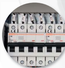
Interruttori magnetotermici per protezione delle linee di misura serie P1 MB (1A curva C 10kA)
