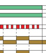
Zeitgesteuertes Ansprechen des Relais beim Schließen eines Kontakts
