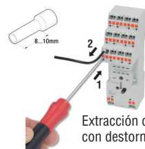
Cableado a presión push-in sin destornillador
