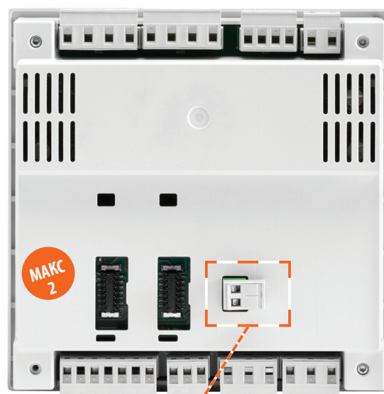
Контактные зажимы для подачи питания 12/24 В пост. тока от батарей (только для ATL601 и ATL610)
