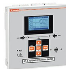
Controler comutator de transfer automat pentru 2 surse de alimentare, control trifazic, cu display LCD, alimentare 12- 24VDC ATL601
